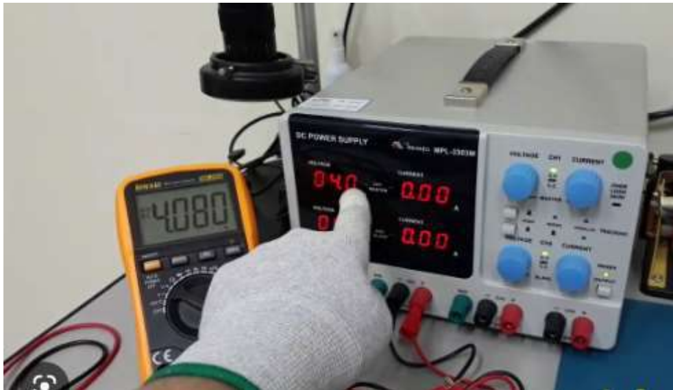
Figura 10 - Divergência de valores entre os terminais-jacaré (aferidos no multímetro) e valores gerados na fonte
